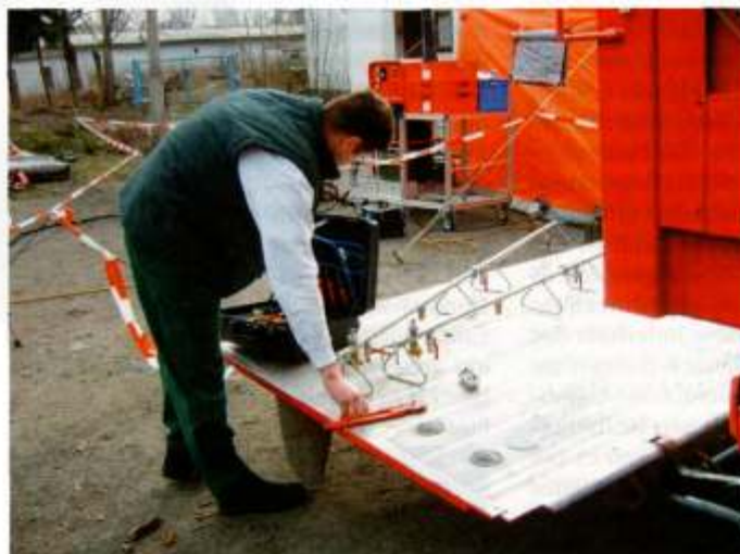
Das eigentlich für Dekon-P-Zwecke vorgesehene Duschgestänge musste für die Dekon-G genutzt werden, da es dafür keine spezielle Ausrüstung gab.
